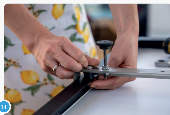
Das Ganze wiederholst du nun auch noch auf der Unterseite der Haken. Distanzhülse und Schraube positionieren...
