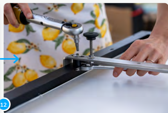
12 ...poi sistemarlo con cura. Anche in questo caso, assicuratevi che la coppia sia corretta (secondo le istruzioni).
