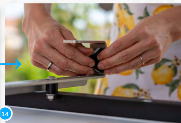
14 Se si dispone di un corrimano quadrato, è possibile ora incollare le strisce di gomma come protezione dai graffi.
