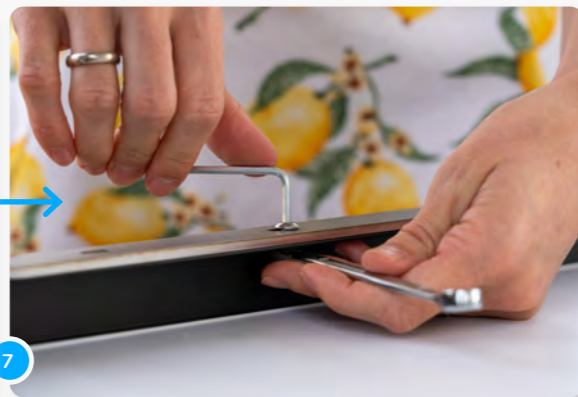
7 Ora è possibile fissare le due staffe con quattro viti e dadi ciascuna.
