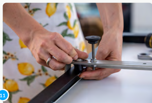
11 Ripetere l'intera procedura sul lato inferiore dei ganci. Posizionare il manicotto distanziatore e posizionare la vite...
