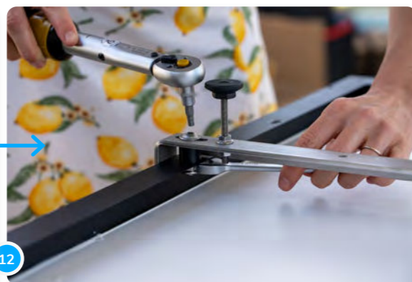
...puis fixe-les soigneusement. Veille ici aussi à appliquer le bon couple de serrage (selon les instructions).
