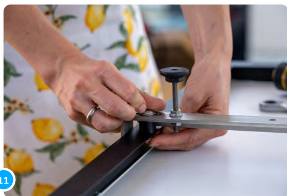
Répète l'opération pour la partie inférieure du crochet. Positionne la douille de distance et la vis...
