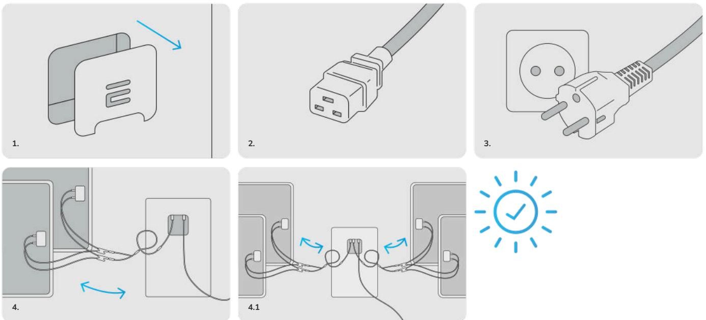
**Hinweis** Wenn du eigene Panele anschließt, dann achte bitte darauf, dass die Eingangsspannung 44V nicht überschreitet und du diese auch nur parallel und nicht seriell anschließt.
